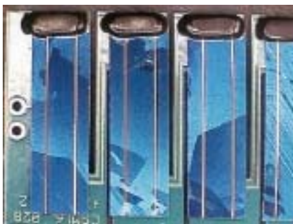
Abb. 8: Die-Bonden, Drahtbonden und Verkapseln der Flex-Demonstratoren
